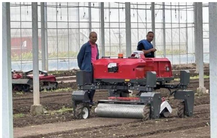
联适导航 4WDS110EV 智能四驱播种机融合了卫星导航与惯性导航技术，解决了弱信号等复杂场景定位问题，有效提高作业质量。同时其具有多种转向模式，可以实现原地转向，降低了对地头距离的限制。
