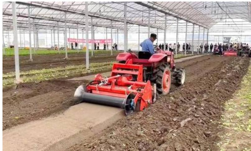
汉美 1G-140P 旋耕起垄机碎土碎茬埋茬的性能较好，能够适应各种作业要求，且作业后地面更加平整，有利于后期机械化标准作业的开展。
