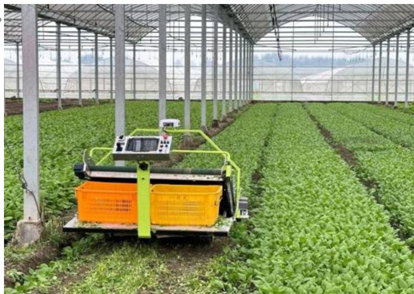
省力科技的 4UM-120LD 叶菜收获机新搭载了联适导航技术，相较于人工操作能够更好地保持直线行走。同时实现了自动规划路径、自动调头，无需人工捡拾，有效降低了劳动强度。
